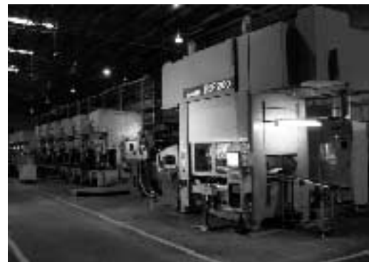
●マレーシア工場に導入されたACサーボプレスH2F200。今後の活躍が期待される。
