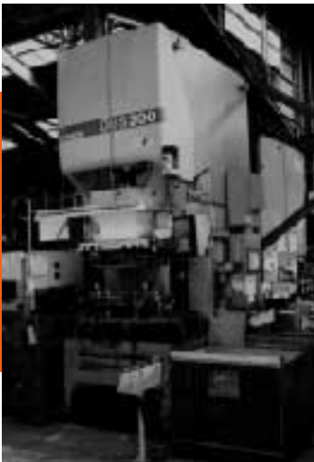
● 順送加工で、省人化、効率アップを実現したコマツOBS200
