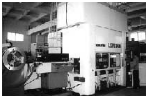
日本国内と同機種のリンクモーションプレス (中国工場)
