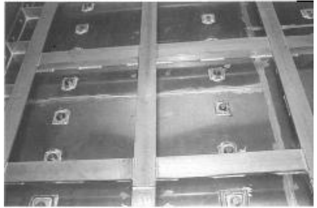
250mmの消音機はアルミ材の溶接構体となっている
